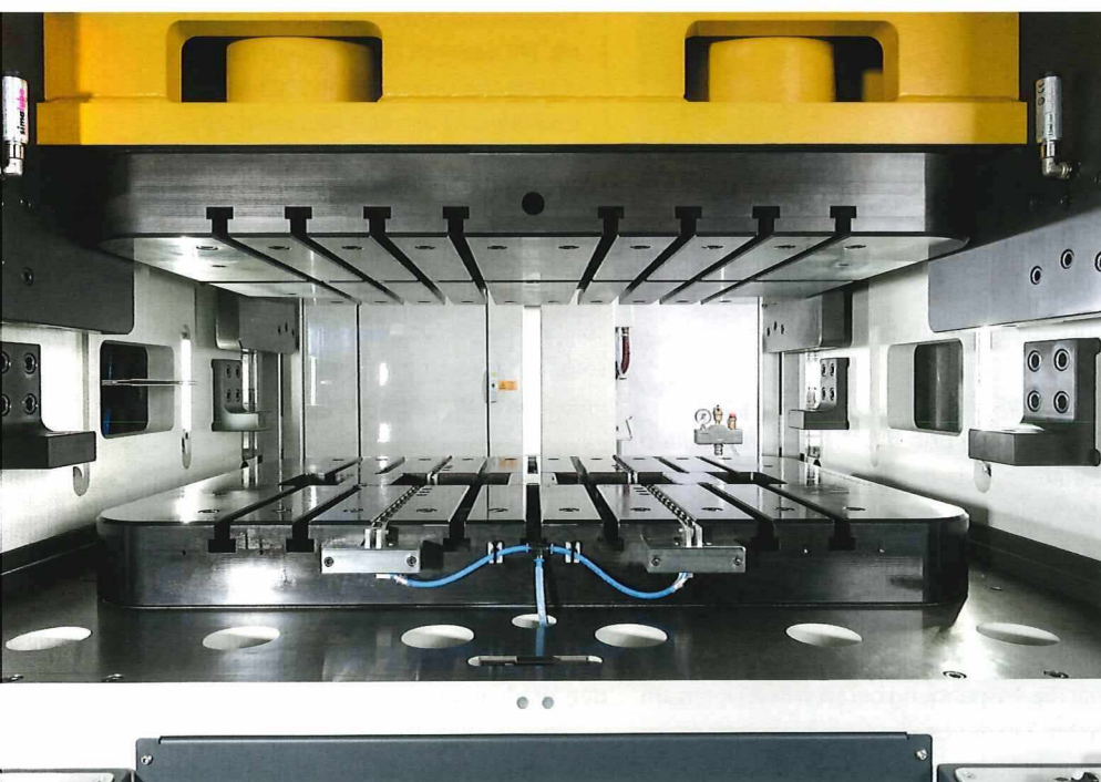
Beispiel einer hochdynamischen Positionieranwendung: In dieser Servo-Hub-Press SHP von Nidec SYS kommt der Drive Controller SD2S von Sieb & Meyer zum Einsatz.
